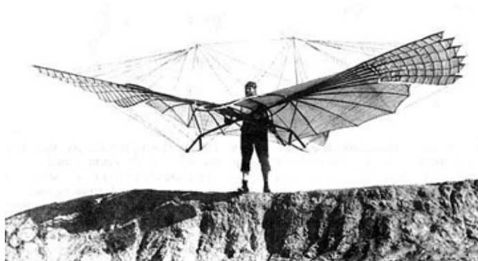
Рис. 2. Орнитоптер с крылом из двух шарнирно соединенных частей
